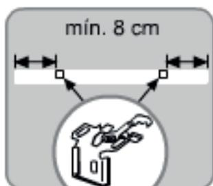
1. Positionner les supports en laissant un minimum de 8cm entre eux et les bords de votre fenêtre.
