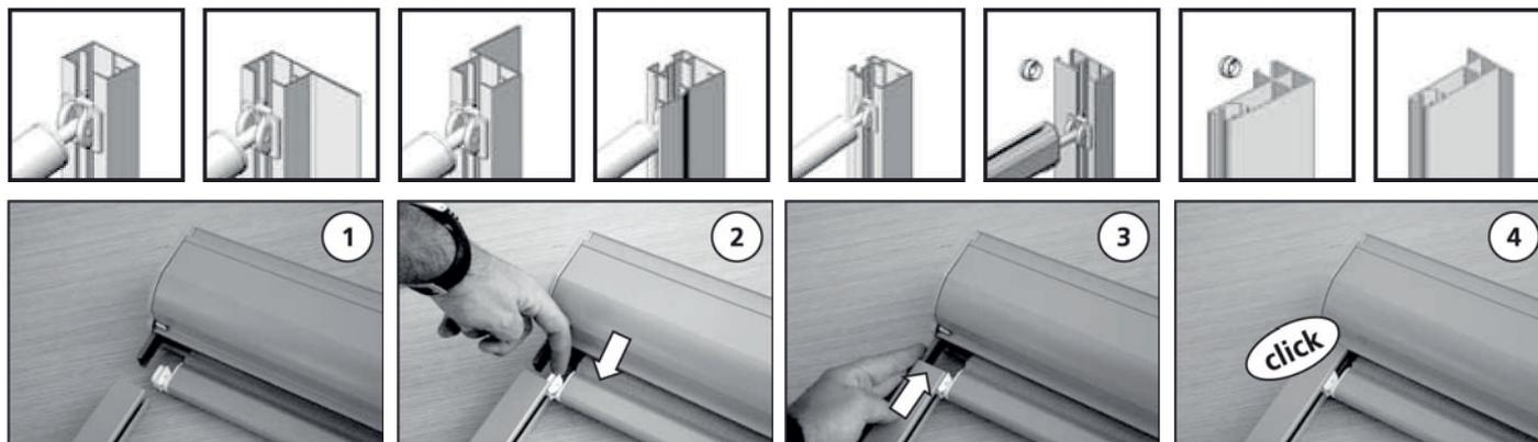
1, 2, 3, 4 : Positionner les différents éléments comme sur l'image 1. Ensuite, insérer l'embout d'extrémité dans la coulisse puis emboîter la coulisse sur le coffre jusqu'à entendre un «Click».
